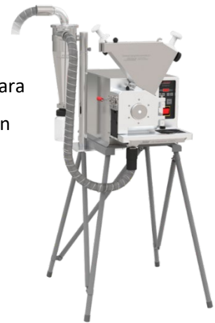
Imagen. 1: molino de corte universal PULVERISETTE 19 y ciclón de alto rendimiento
